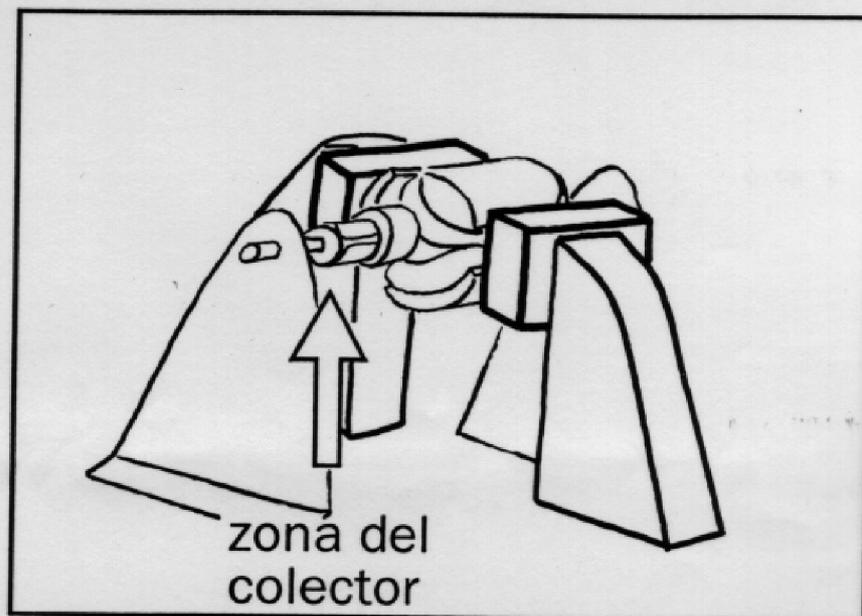
Inmovilizarlos cerca del rotor, de modo que no se desplacen los imanes al hacer girar el rotor a mano. No se debe invadir la zona del "colector"
